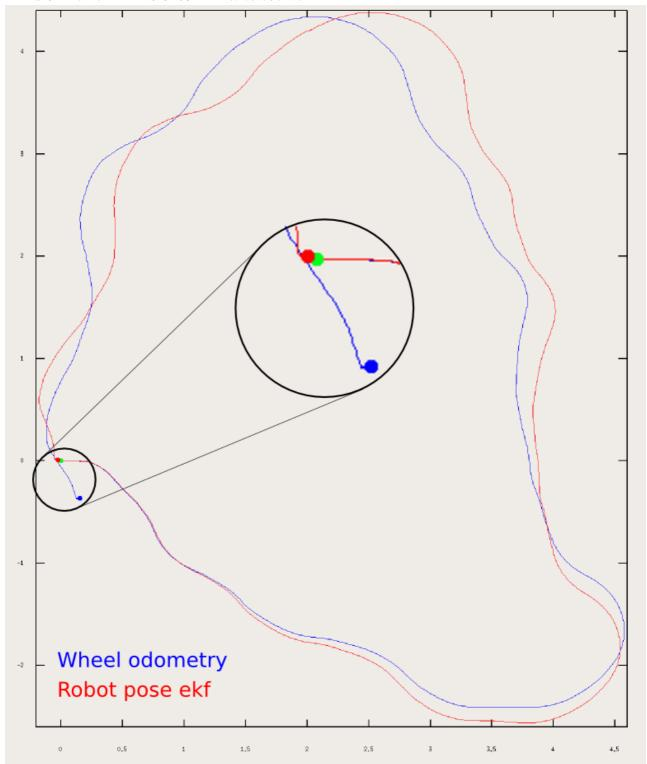
PR2从实际初始点(绿色)溜达一圈回到初始点(绿色),编码器的里程(蓝色)发生了漂移,而使用 robot\_pose\_ekf融合出来的里程(红色)则跟实际位置基本重合(后面我们会针对这个测试下效果)
