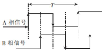
旋转方向为正向时，A相上升沿对应B相低电平 -> B相上升沿对应A相高电平 -> A相下降沿对应B相高电平 -> B
