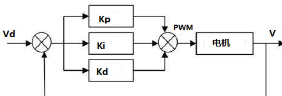
在实际操作中，由于是通程序进行PID的计算，无法达到连续的积分和微分计算，所以用离散处理。给定PID控制频率，周期性地对PID控制计算。
