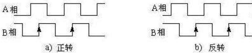
例如上图中的增量式编码器脉冲，当编码器正转时，B相脉冲的上升沿对应A相高电平，而当编码器反转时，B相上升沿对应A向低电平。如此判断旋转方向。
