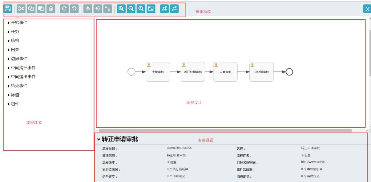
流程设计页面分为：功能按钮区、流程环节区、流程设计区以及参数设置区。
