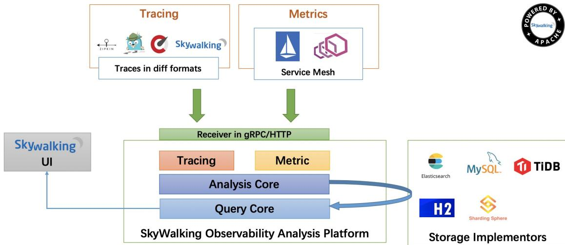
Skywalking主要由三大部分组成：agent、collector、webapp-ui。我们可以使用Skywalking agent探针无侵入地接入到Spring Cloud应用，然后agent探针将应用数据采集到collector收集器。collector中的数据存储在Elasticsearch、H2、MySQL、TiDB中（通过配置文件指定存储方式，默认是H2），通过webapp-ui界面，将这些数据展现给用户。
